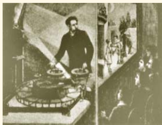
Retroproiezione con sistema di prismi e specchi
